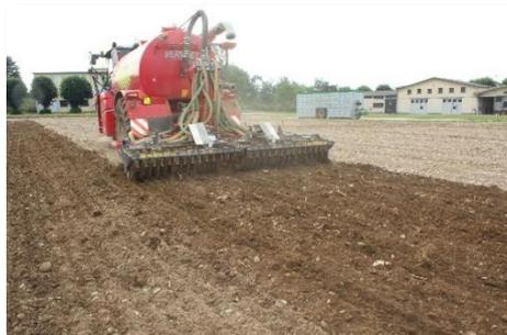
Fig. 1 – Interramento a rateo variabile di digestato
